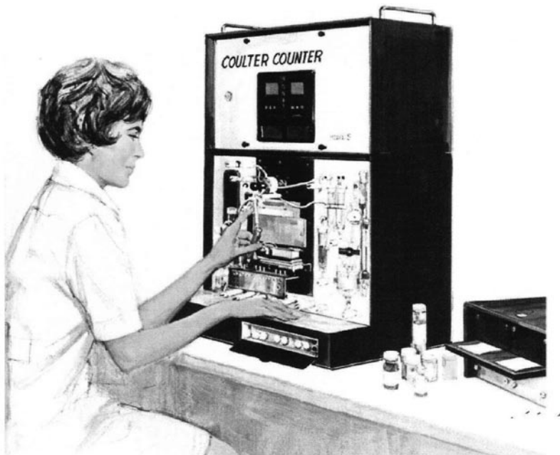
Obrázek 2: Coulter Counter model S (Zdroj: www.bloodjournal.org ).
